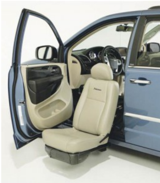
Рис. 2. Крісло для посадки особи з інвалідністю з електронним управлінням
